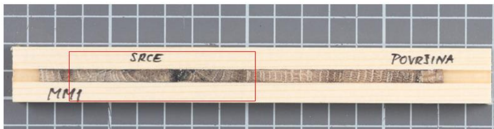
Slika 12. Izvrtak sa slike 11 pokazuje da je ca 2 cm površine propalo, ali da je i srčani dio pilota zaražen, uz zadržanu prirodnu anatomsku strukturu drva.
