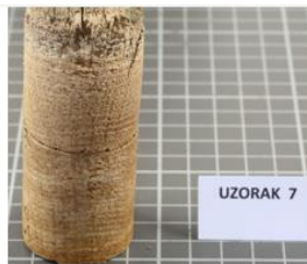
Slika 39. Na prvom stupištu je donji dio trupca oštećen rjetkim poplavlivanjem i odbijenom oborinskom vodom, ali samo u debljini od oko 2 cm (bjeljike). Drvo srži ima zdravu boju i konzistenciju.
