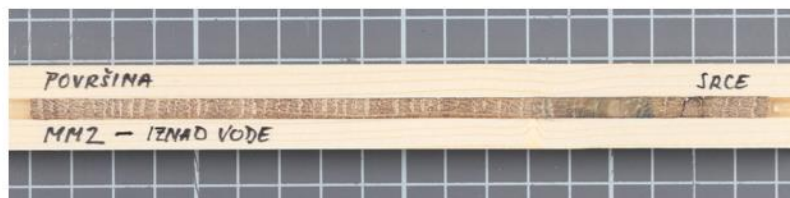
Slika 41. Izvrtak iz naglavne grede pokazuje zdravu, prirodnu boju i strukturu hrastovine, bez tragova truleži
