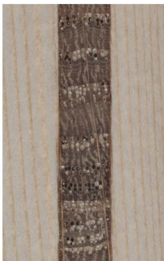
Slika 19. Detalj sa sl. 18. Mikrografija poprečnog presjeka izvrtka iz zdrave srčevine trupca. Jasno razlučive anatomske karakteristike hrastovine: pore ranog drva jasno vidljive, otvorene ili zapunjene tilama, pore kasnog drva u radijalnim nizovima, traci oštri i jasni.
