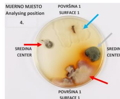
Slika 56. Mikrobiološka kultura sa mjernog mjesta MM 4. Na sva četiri iverčica razvijaju se mikrobiološke kulture. Na gornjem površinskom iverčiću razvila se bakterijska kultura (svjetlo plava strelica). Na donjem površinskom iverčiću intenzivno se razvija micelij gljiva truležnica (crvena strelica) uz inicijalni razvoj plijesni. Na lijevom iverčiću izuzetom iz središnjeg dijela grede razvija se micelij plijesni i micelij gljive truležnice (crvena strelica). Na desnom iverčiću izuzetom iz središnjeg dijela grede intenzivno se razvija micelij gljiva promjene boje (siva strelica).
