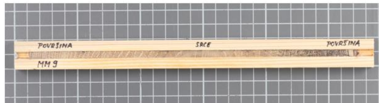
Slika 35. Izvrtak iz srednjeg stupa četvrtog stupišta (MM 9), proboj kroz cijeli stup: Površina s desne strane, uz pukotinu, jako zaražena, dok preostali dio stupa ima konzistentnu strukuru i normalnu boju.
