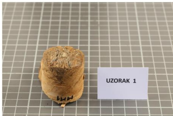
Slika 11. a) i b). MM 1. Mjesto cilindričnog izvrtka ca 30 cm iznad trulog čela kosnika (slika desno) pokazuje da je površina zaražena i izjedena do dubine od ca 2 cm, dok dublje zone izgledaju kompaktno i zdravo.
